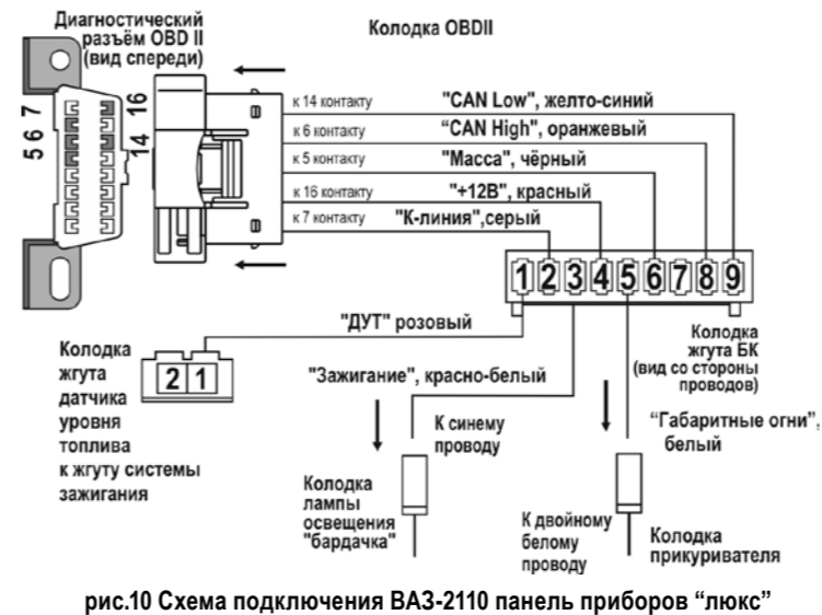
рис.10 Схема подключения ВАЗ-2110 панель приборов "люкс"
