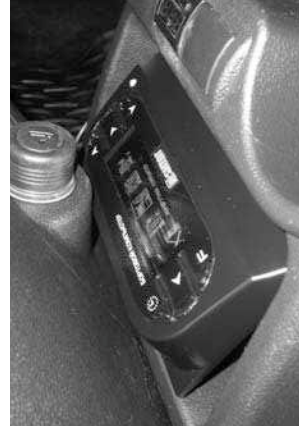
Рис.2 Вид установленного БК
