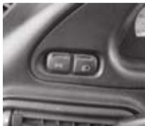
Рис. 7 Выключатель наружного освещения
