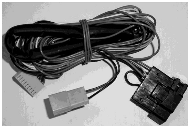
Рис. 1 Жгут для подключения БК
